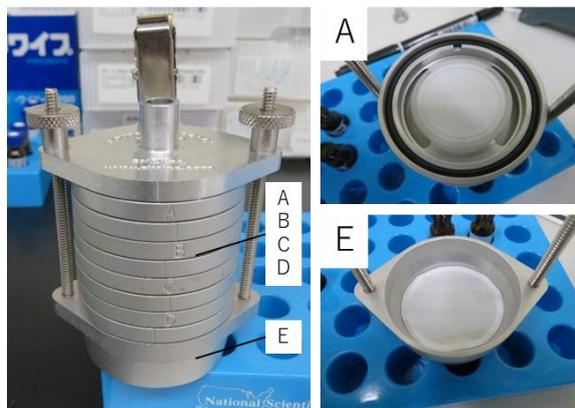
図1 インパクター(左)とその分解図(右)
