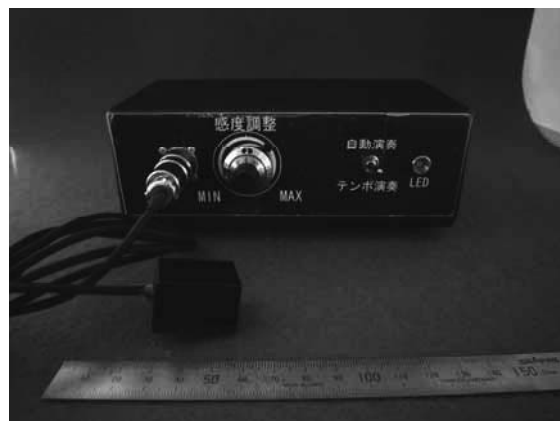
図4 試作した加速度センサ利用スイッチ
